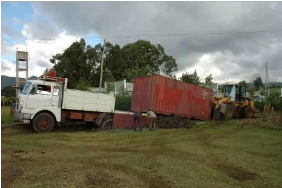
hjullasteren drar containeren av lastebilen.
